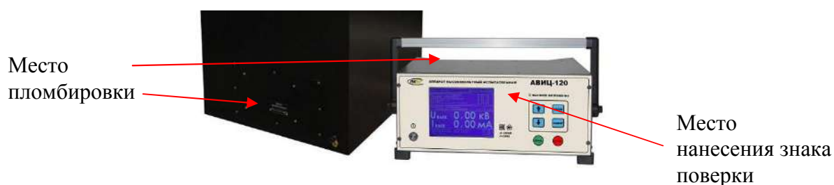
Рисунок 2 - Место пломбировки от несанкционированного доступа и нанесения знака поверки
