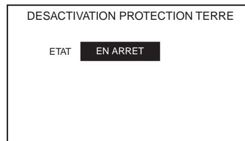
Figure 49 – Écran d'arrêt de désactivation protection terre
