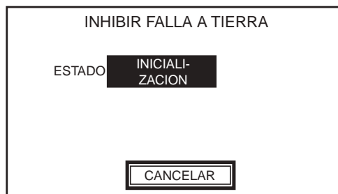
Figura 47 – Pantalla de inicialización “Inhibir falla a tierra”
